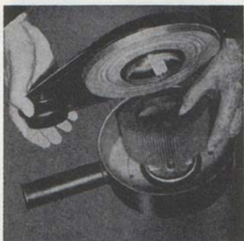
Bild 15. Byte av insats (B 18 A).
